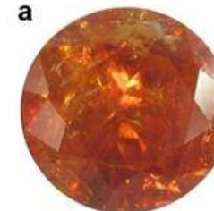
Ограненный кристалл термообработанного касситерита месторождения Мерек (диаметр 6,7 мм, масса 2,2 ct).
